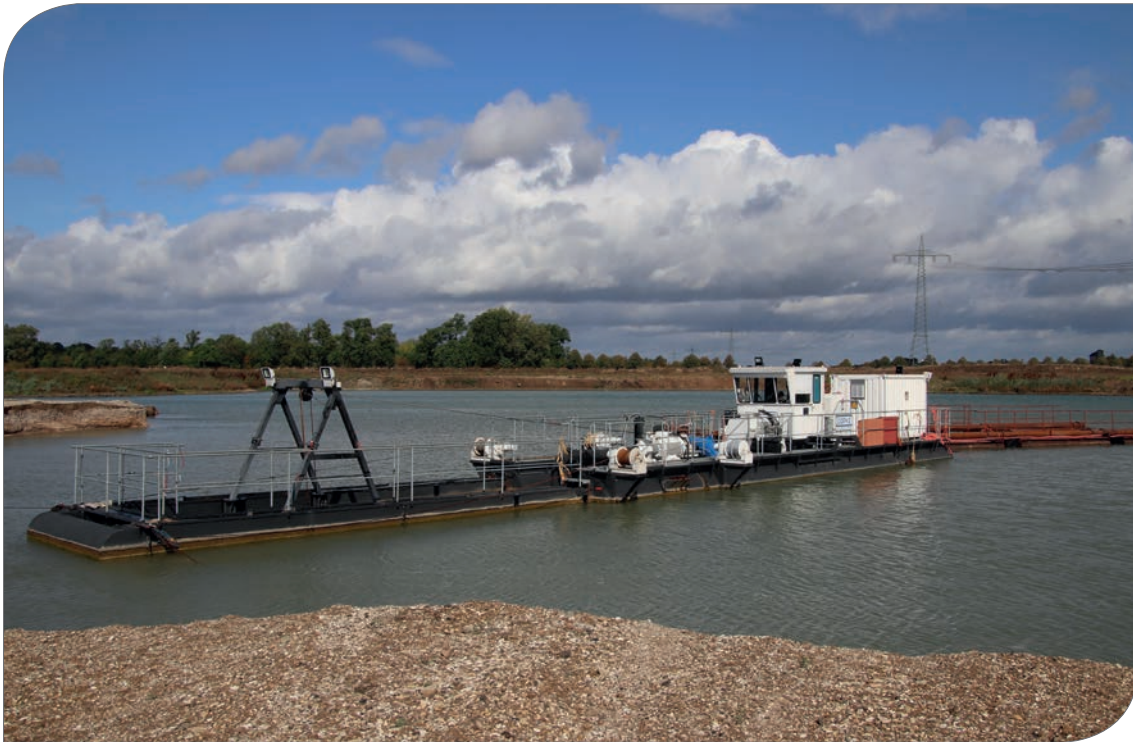
Abb. 1: Kiesgewinnung an der Leine südlich Hannover. Obwohl es natürlich auch viele Trockenkiesgruben gibt, erfordert der meist hohe Grundwasserspiegel häufig eine Kiesgewinnung im Nassabbau, was in der Anlage eines Baggersees resultiert, Foto: BGR.
